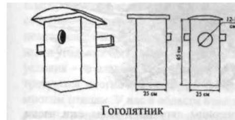
Некоторые конструкции искусственных гнездовий для уток
