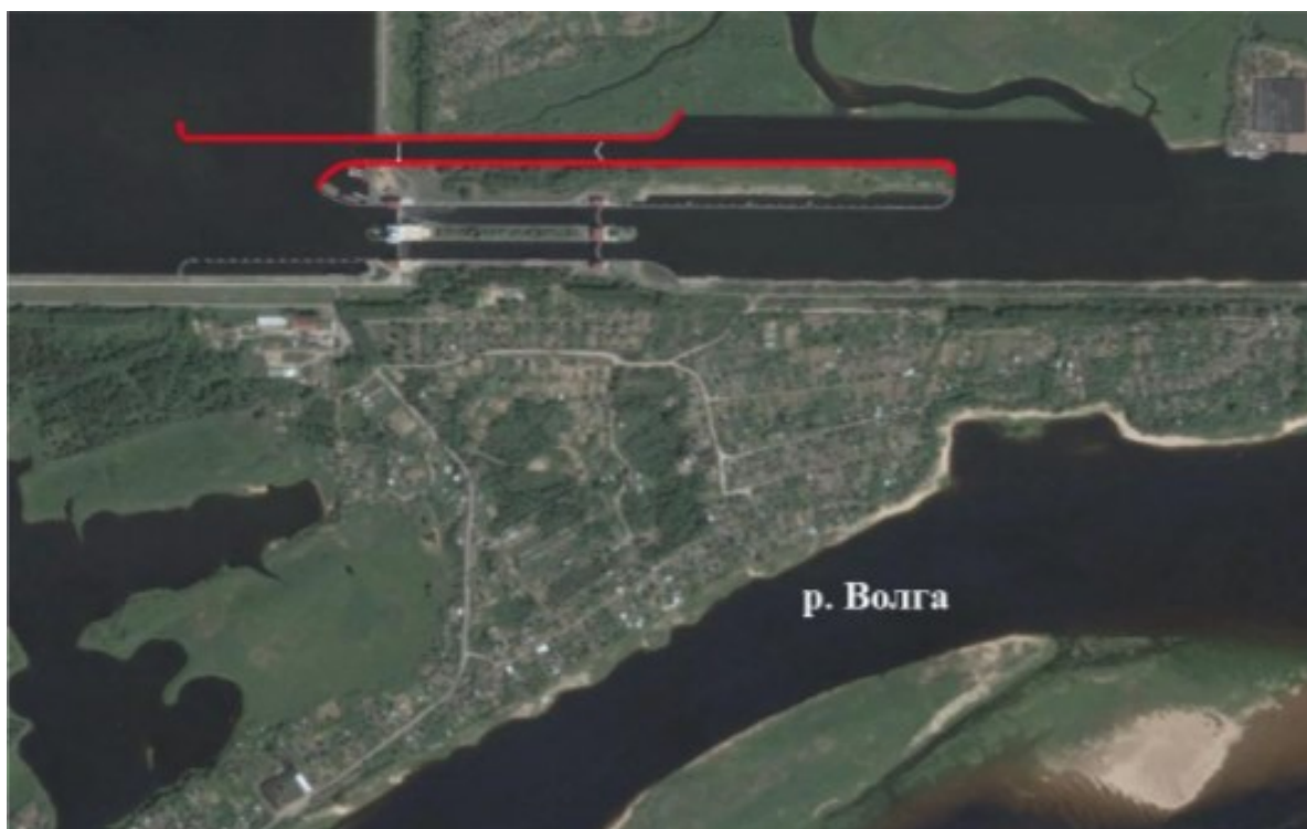
Рис. 6. Вариант строительства третьей нитки судоходного шлюза.
